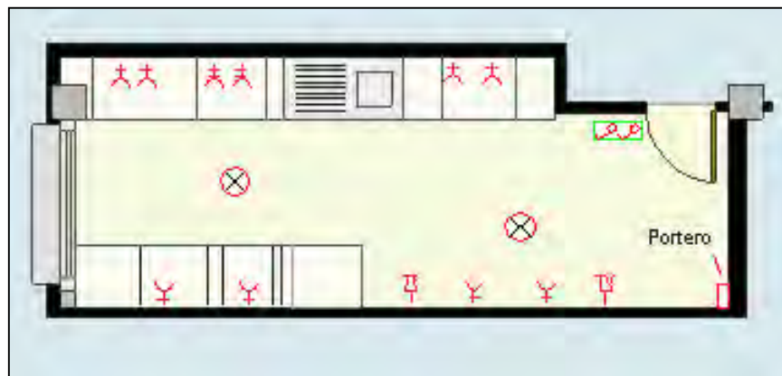
Figura G: Plano de planta de la cocina
