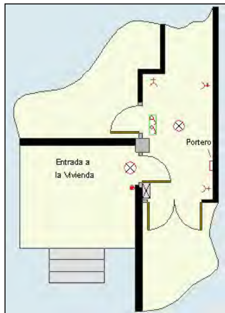
Figura D: Plano de planta del acceso de la vivienda y el vestíbulo
