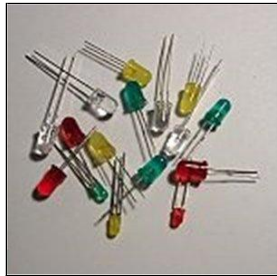
son los diodos LED (Diodo emisor de luz, o en inglés, Light Emitting Diode ).
